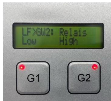
Wird Low ausgewählt, ist das Relais unterhalb des Grenzwertes G2 geöffnet und schließt bei Überschreitung von G2.
